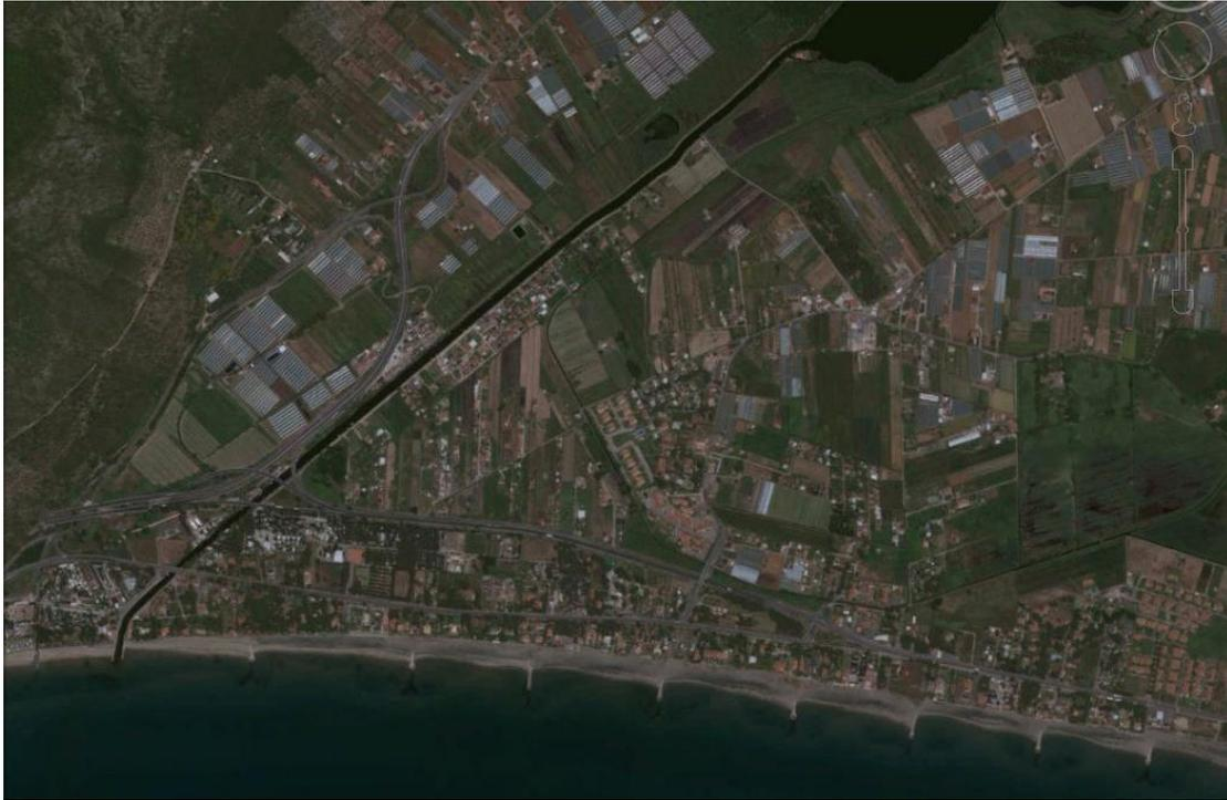
Figura 8-52 Difesa realizzata mediante pennelli tra le foci del Fiume Canneto e Canale S. Anastasia emissari del Lago di Fondi
