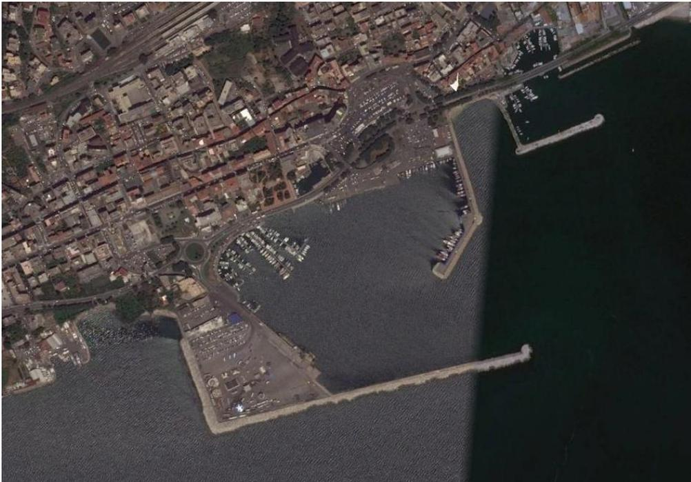
Figura 8-56 Porto di Formia e utilizzo di un'opera di difesa costiera per l'ormeggio delle imbarcazioni
