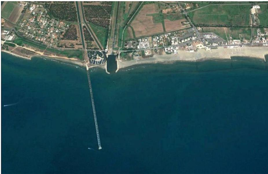
Figura 8-36 Foce Verde: opera di presa della ex centrale nucleare, armatura della foce del Canale Mussolini e opere di difesa a celle del lido di Latina.
